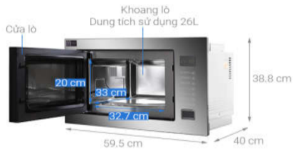
Kích thước lắp đặt lò vi sóng âm
