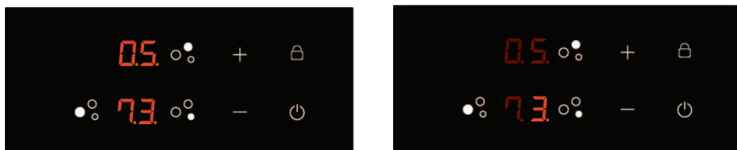
Hình 6: Lựa chọn 3 mức công suất. Lựa chọn kết thúc vùng nấu
